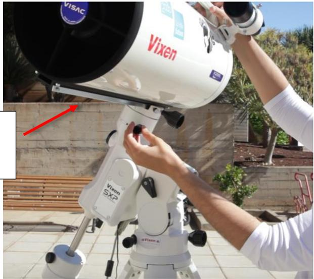
6. Aflojamos los tornillos de la ranura (primero el metálico y después el negro).
