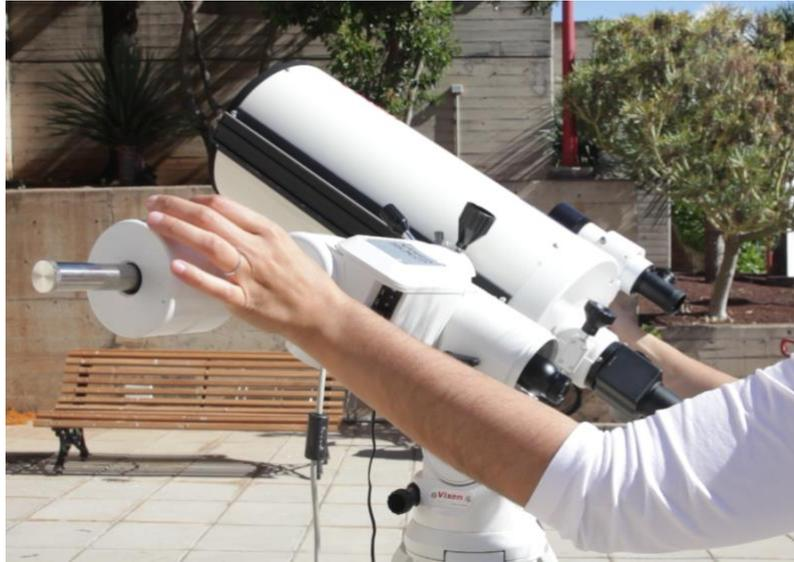
3. Fijamos el freno de ascensión recta para mantener el telescopio en la posición horizontal.
