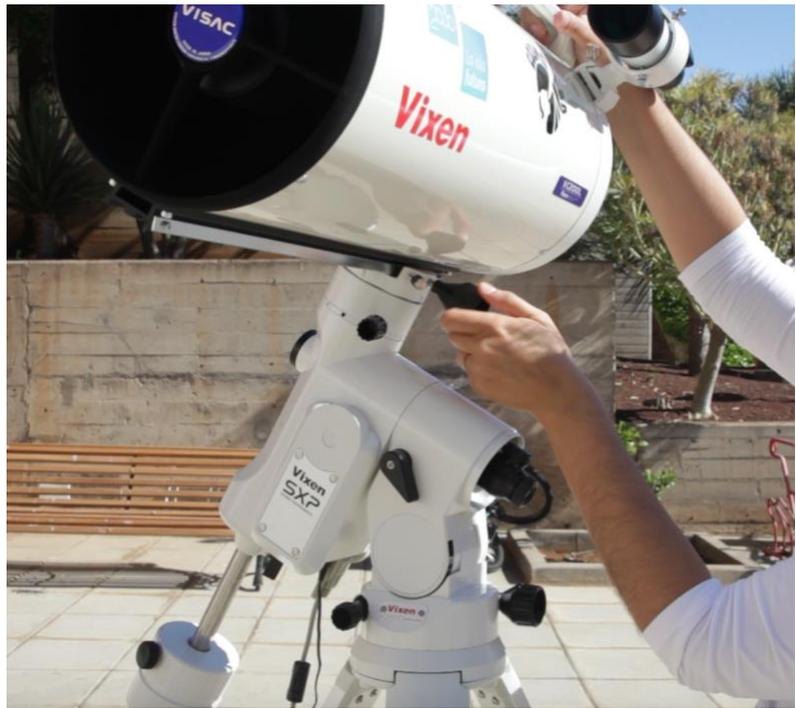
7. Desplazamos el tubo hacia atrás o hacia delante, cogiéndolo por el asa, hasta la posición adecuada y apretamos de nuevo los tornillos.
