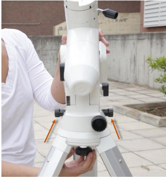
*Nota: El tornillo de la parte superior del trípode debe encajar en el hueco "interno" de la montura. Si es necesario soltamos un poco los dos tornillos negros marcados con las flechas para que entre fácilmente.*
