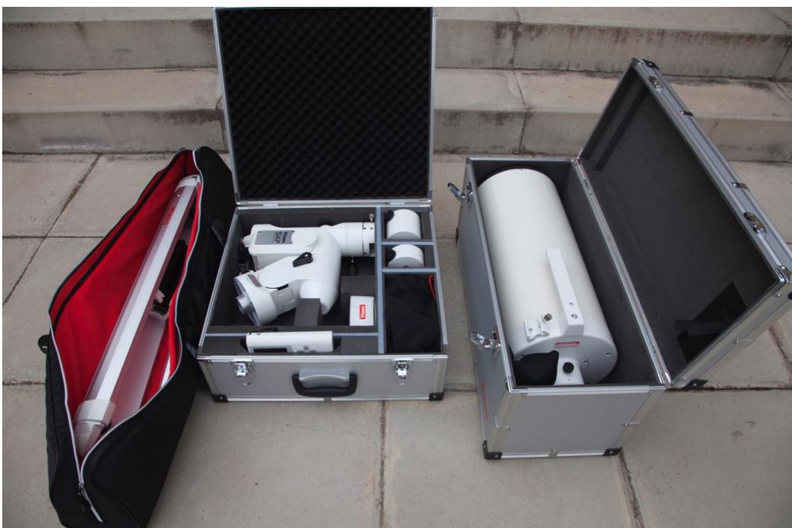
En la caja cuadrada se encuentra la montura Vixen SXP, junto con el control electrónico, los oculares, los pesos, la bolsa de los cables y la batería.
