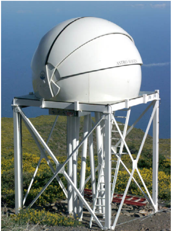
Monitor de Seeing "RoboDIMM" del Grupo de Telescopios Isaac Newton, instalado en el Observatorio del Roque de los Muchachos (La Palma).
